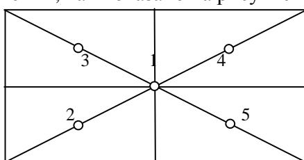
Гиры не должны выходить за пределы платформы. При каждом положении гирь регистрируются показания весов. Погрешности весов при нецентральном положении нагрузки рассчитывают по формулам (2) и (3).
