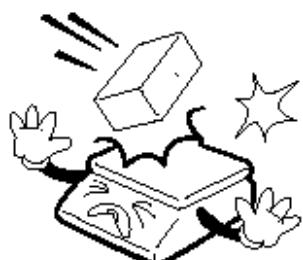
Не допускайте резких ударов по платформе весов во избежание повреждения внутренних устройств.
