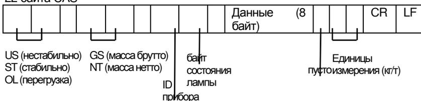
*Примечание 1. ID прибора: Отправка 1 байта с ID устройства для индивидуального получения данных с конкретного прибора WTM по идентификатору ID (ID устройства задается параметром F26).*
