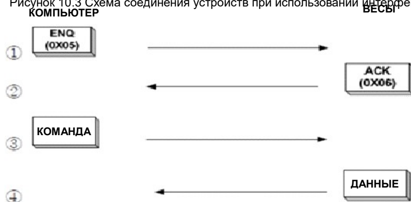
Рисунок 10.4 Схема обмена данными в командном режиме
