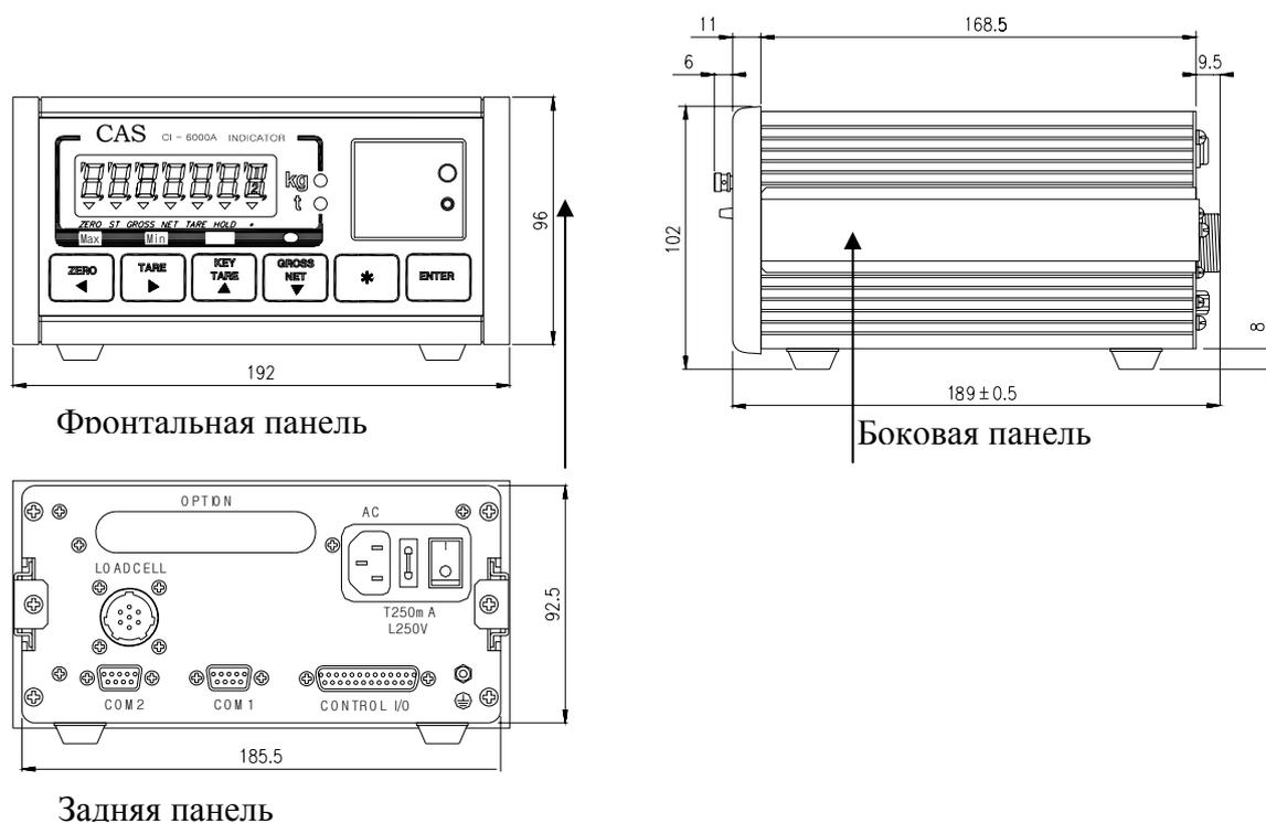
Рисунок 4.2 Вид и геометрические размеры фронтальной, задней и боковых панелей индикатора
