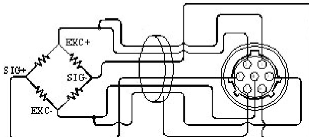
Рисунок 6.1 Схемы подключения тензодатчика
