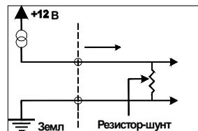
Например, если значение функции F46 установлено в 4мА, функции F47 - в 20мА в режиме настроек и сопротивление резистора-шунта 250Ω, выходное напряжение 1V ~ 5V.
