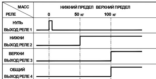
Если установилось стабильное состояние весовой системы и масса груза превысила верхний предел, общий выход реле будет находиться в состоянии «включено».
